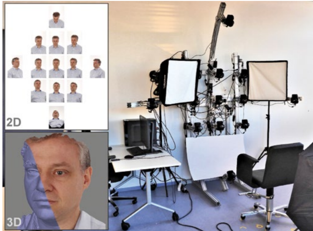
Der Name ist Programm: Der K13-Aufnahmestand zur Gesichtsbimetrie besteht aus 13 Kameras, die gleichzeitig eine Aufnahme auslösen können
